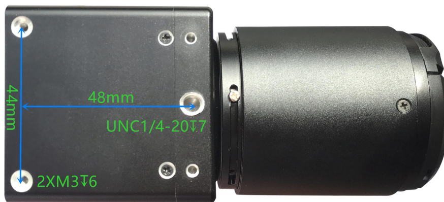
图 3.2 机械安装孔尺寸
